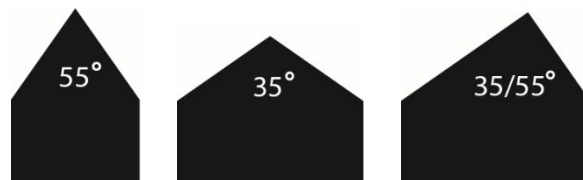
Taghældninger der kan godkendes. Hældninger der ligger i mellem 35 og 55 grader kan også godkendes.
